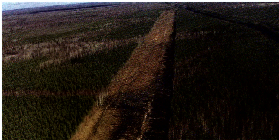
Вид с вертолета на разрубленную охранную зону ВЛ 750 кВ (Кировский район Ленинградской области)
